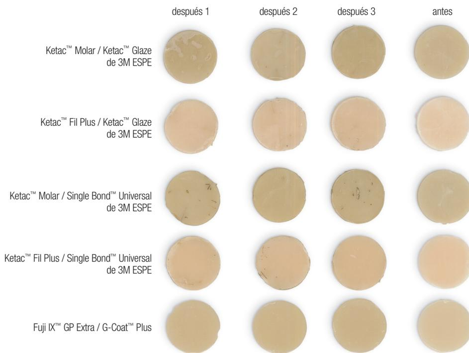
Figura 49: Imágenes de muestras del Restaurador de ionómero de vidrio Ketac™ Molar y del Restaurador de ionómero de vidrio Ketac™ Fil Plus Aplicap™ recubiertas con el Barniz fotopolimerizado Ketac™ Glaze y el Adhesivo Single Bond™ Universal de 3M ESPE, en comparación con Fuji IX™ recubierto con G-Coat™ Plus después de sumergirlas en café.
