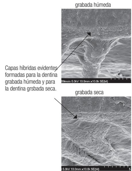
Figura 29: Dr. J. Perdigo, Universidad de Minnesota. Resistencia a la microtracción del Adhesivo Single Bond™ Universal de 3M ESPE en dentina autograbada, en comparación con dentina húmeda y seca en el modo de grabado total. Las muestras secas se secaron durante 10 segundos después del grabado y el enjuague.
